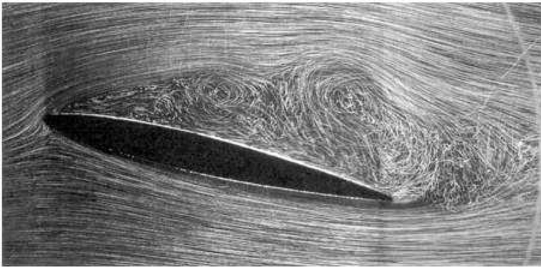
Écoulement décollé sur un profil d'aile. Photo ONERA,
